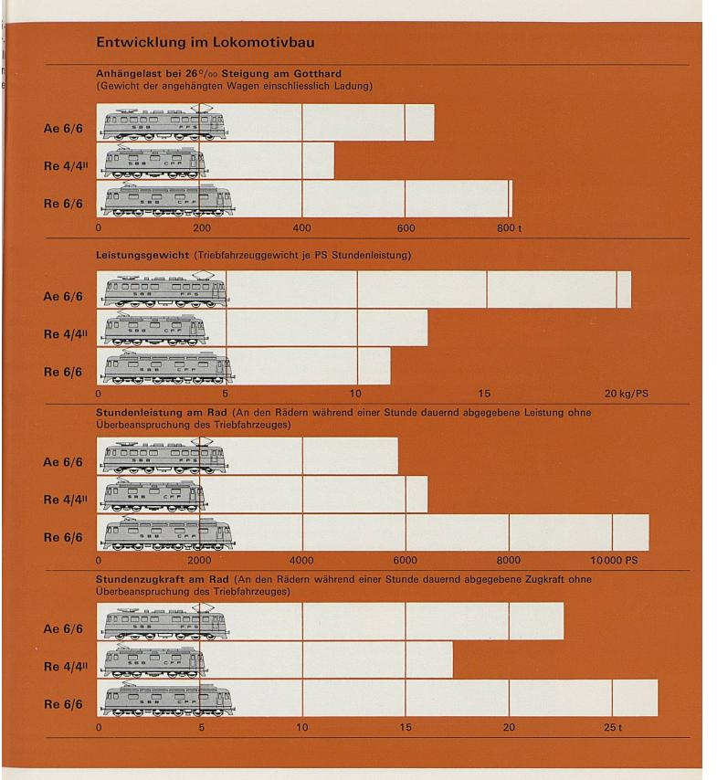
einem vierachsigen Triebfahrzeug nicht möglich, den Grenzwert der Lokomotive Ae6/6 zu übertreffen. Will man die Doppeltraktion mit den Lokomotiven Re4/4<sup>II</sup> und Re4/4<sup>III</sup> in möglichst vielen Fällen vermeiden, so kommt man gezwungenermassen zu einem sechsachsigen Triebfahrzeug.
