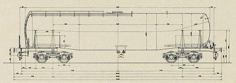
Kesselwagen für Mineralöltransporte, Typ Uahs (Fassungsvermögen 95 m³)
