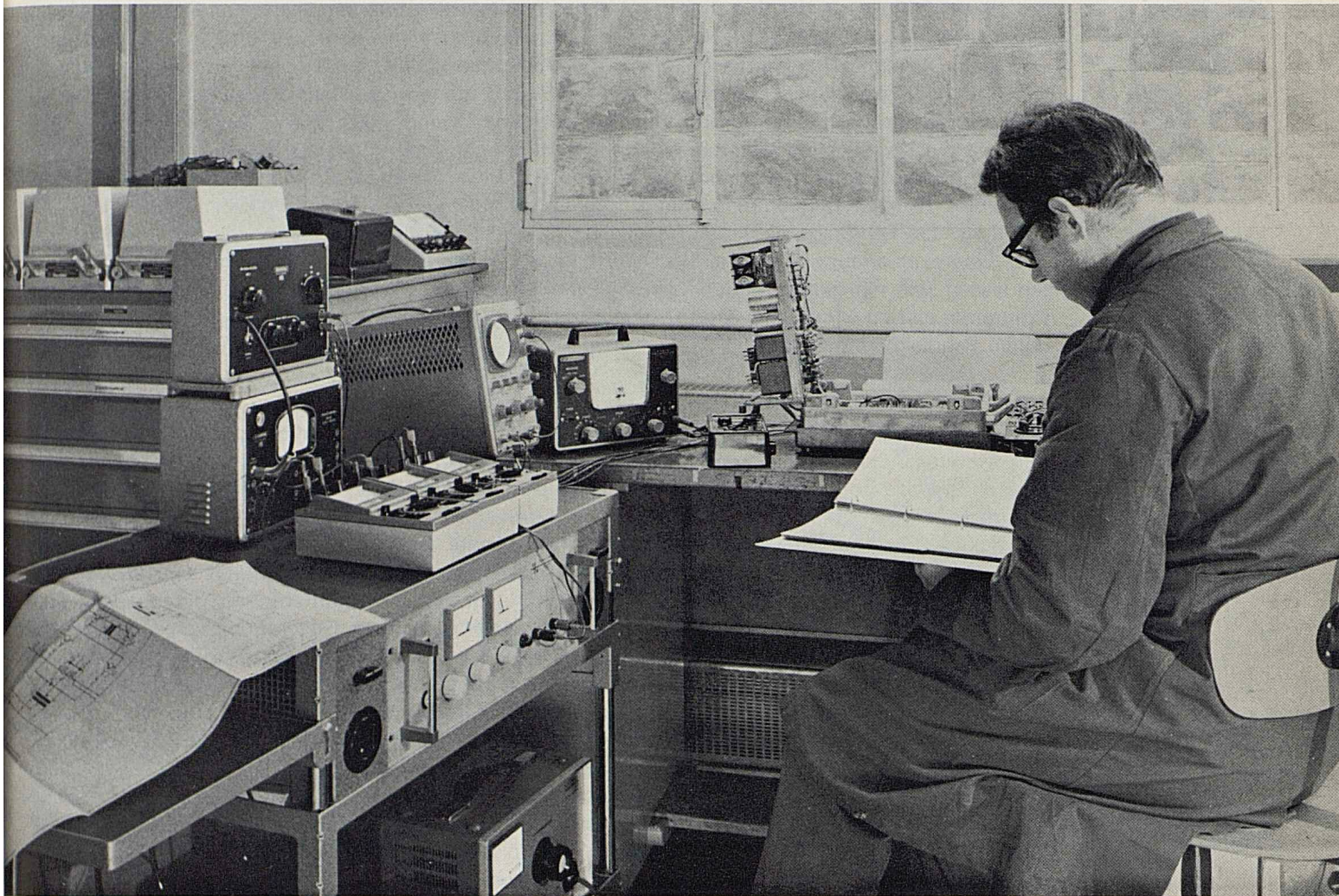
Prüfung und Unterhalt elektronischer Geräte der Triebfahrzeuge
