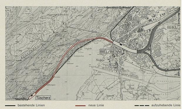
Der neue, 2431 m lange doppelspurige Tunnel zwischen Tüscherz und Biel ist praktisch vollendet und kann seit dem 14. März 1969 einspurig und ab Fahrplanwechsel am 1. Juni 1969 doppelspurig befahren werden. Auf dem Bild nebenan ist links die alte einspurige Linie ersichtlich, die abgebrochen und deren Trasse dem Kanton Bern für den Bau der Nationalstrasse N 5 abgetreten wird.
