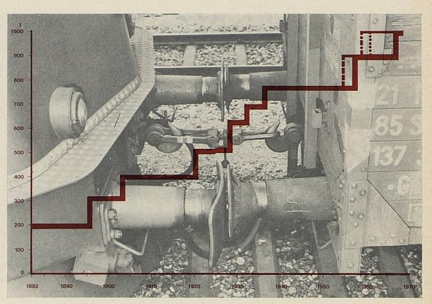
Entwicklung der zulässigen Anhängelast am Gotthard mit Rücksicht auf die Fahrzeugkupplungen
