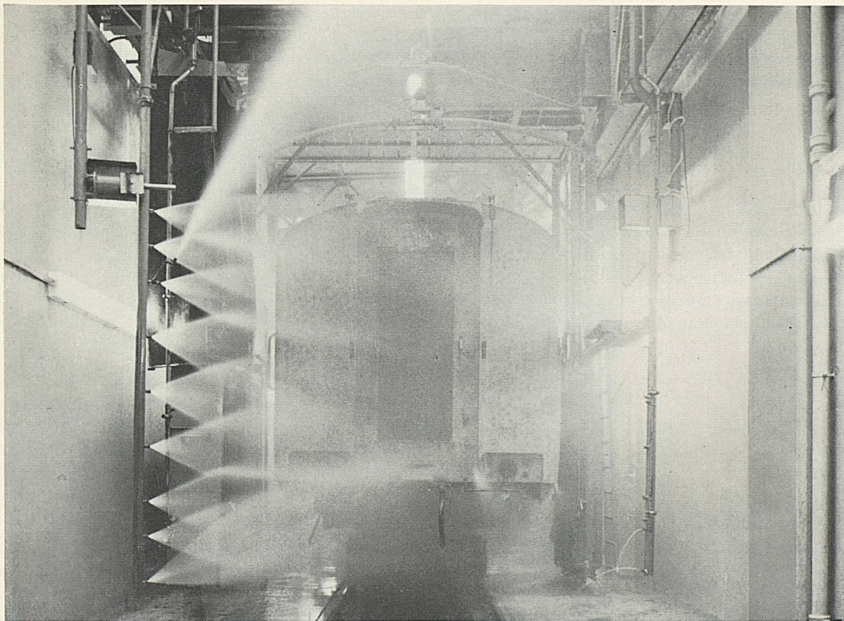
Die neue Ablauganlage der Werkstätte Zürich ermöglicht ein rasches, automatisches Entfernen alter Farbanstriche an den Fahrzeugen.
