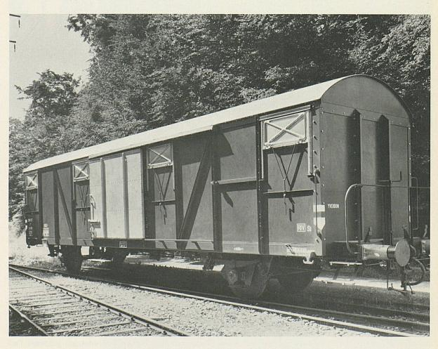
Der neue Grossraum-Güterwagen des Typs Hbs (früher J 4) mit 87 m³ Laderaum und einer Tragfähigkeit von 26 t
