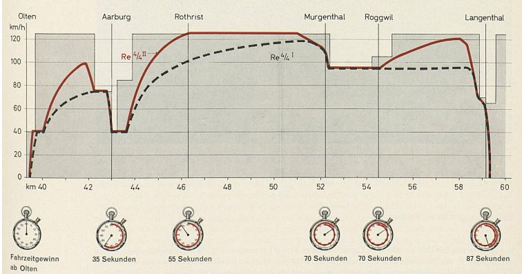
Der Fahrzeitgewinn eines mit der neuen Lokomotive Re 4/4" geführten Schnellzuges (rote Kurve) im Vergleich mit demselben, von einer Lokomotive Re 4/4" geführten Zug (schwarz gestrichelte Kurve) beträgt auf der rund 20 km langen Strecke Olten-Langenthal allein dank der größeren Zugkraft nahezu 1½ Minuten. Die theoretisch ausnützbare Streckengeschwindigkeit wird durch die obere Begrenzungslinie der schwarz schraffierten Fläche dargestellt.
