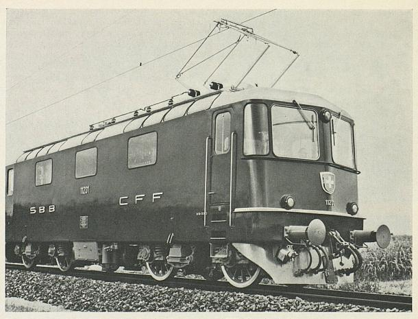
Die neue Lokomotive Re 4/4" mit einer Stundenleistung von rund 6500 PS ist für die Führung schwerer Städteschnellzüge und Güterzüge im Flachland sowie für Mehrfachtraktion auf Bergstrecken bestimmt. Welche Fahrzeitgewinne diese Hochleistungslokomotive im Vergleich zu ihrer Vorgängerin Re 4/4" (rund 2500 PS) zu erzielen vermag, veranschaulicht der nachfolgende Vergleich der Fahrdiagramme.
