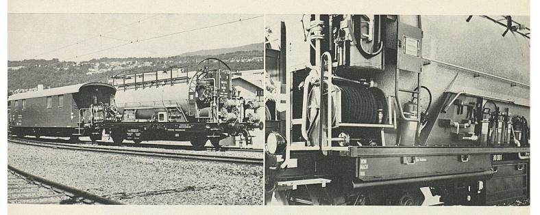
Der neue Löschzug der SBB besteht aus einem fahrdrahtunabhängigen Triebfahrzeug, einem Tanklöschwagen und einem Rettungswagen.
