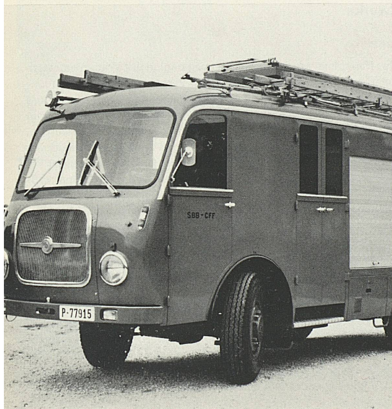
Prototyp eines schienen- und straßengängigen Montage-Wagens für den Fahrleitungsunterhalt. Dieses kombinierte Fahrzeug wird nicht allgemein Montage-Wagen bereit zum Einsatz. Der Wagen begibt sich auf das Geleise, um auf die Schienen umgesetzt zu werden.
