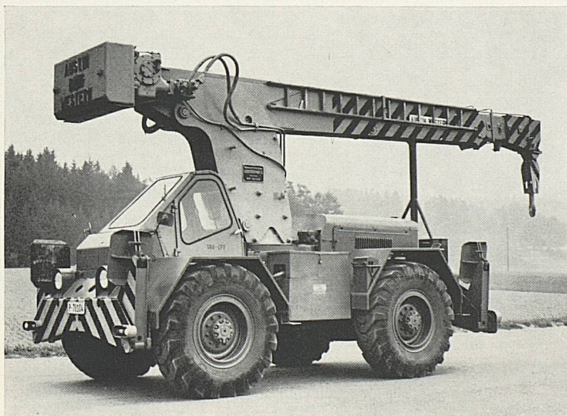
Der neue fahrbare Straßenkran wird für den Unterhalt von Fahr- und Übertragungsleitungen sowie für den Einbau von Weichen auf Großbaustellen eingesetzt.
