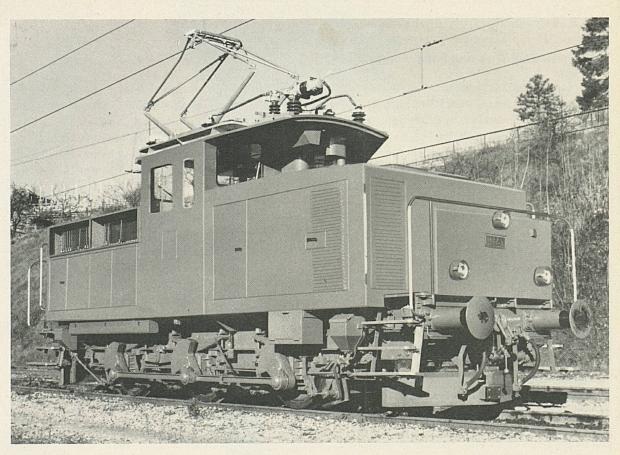
Rangierlokomotive der Serie Ee<sup>3</sup>/<sub>3</sub> IV für die folgenden vier Stromsysteme: 15 kV 16<sup>2</sup>/<sub>3</sub> Hz (SBB), 3 kV Gleichstrom (FS/Chiasso), 1,5 kV Gleichstrom (SNCF/Genf), 25 kV 50 Hz (SNCF/Basel)
