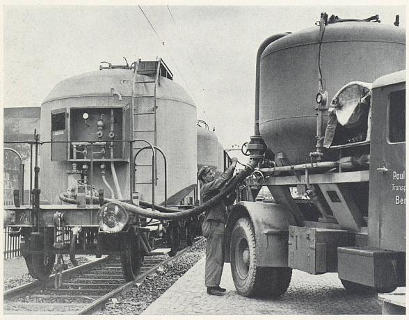
Zement und andere staubförmige Schüttgüter werden heute vorwiegend mit Zementsilowagen transportiert. Pneumatische Vorrichtungen ermöglichen einen mühelosen, raschen und wirtschaftlichen Umschlag
