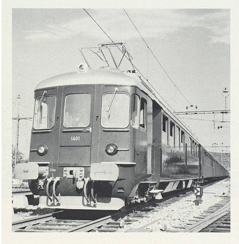
Bild links: Ein neuer RBe4/4-Personentriebwagen führt einen Städte-Pendelzug zwischen Genf und Zürich. Stundenleistung der Triebmotoren = 2800 PS bei 80 km/h. Höchstgeschwindigkeit = 125 km/h. Sitzplätze = 68
