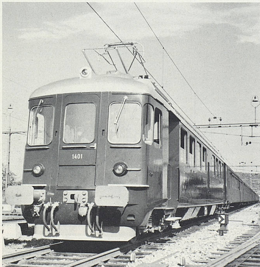
Bild links: Ein neuer RBe 4/4-Personentriebwagen führt einen Städte-Pendelzug zwischen Genf und Zürich. Stundenleistung der Triebmotoren = 2800 PS bei 80 km/h. Höchstgeschwindigkeit = 125 km/h. Sitzplätze = 68
