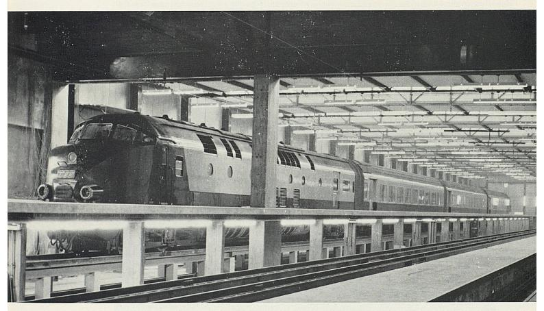
Der moderne und komfortable TEE-Zug ist in die neue Halle des Depots Zürich eingefahren und erhält hier eine sorgfältige Pflege. Eine erhöhte Arbeitsbühne erlaubt den Depotarbeitern ein rationelles Arbeiten auf zwei Ebenen.
