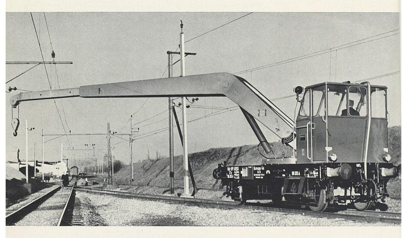
Dieser Kranwagen mit einer Tragfähigkeit von 4 t ist im Fahrleitungsdienst eingesetzt. Er hilft vor allem bei der Montage von Fahrleitungsmasten und -trägern
