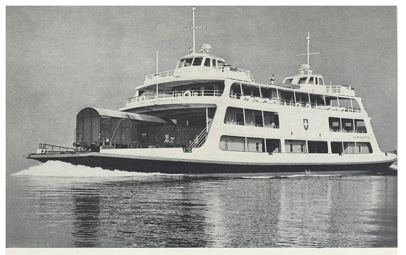
Das neue Mehrzweckschiff «Romanshorn» für die Beförderung von Passagieren und Automobilen zwischen Romanshorn und Friedrichshafen kann auch für die Trajektierung von Güterwagen eingesetzt werden
