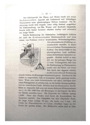
Abb. 6: Die von Michaud zur Bestimmung der elektrischen Leitfähigkeit benützte Apparatur, S. 12 der Inauguraldissertation. Auf eine solche Apparatur bezog sich wohl Klee, als er den Ausdruck »michaudysieren« prägte (s. Abb. 4).
