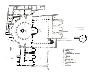
Abb. 6: Jerusalem, Anastasis, Grundriss des Zustandes nach dem Wiederaufbau vor 1048, (Rekonstruktion von V. Corbo, umgezeichnet J. Krüger).
