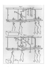
Abb. 3: Vorrichtung zum automatischen Wiegen von Schweinen in Schlachthäusern. U. S. Patent 92083, 29. Juni 1896 (Quelle: Giedion, Sigfried, Mechanization Takes Command – A Contribution to Anonymous History. New York 1948).
