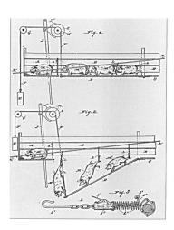
Abb. 4: Apparat zum Einfangen und Aufhängen von Schweinen. U. S. Patent 252ll2, 10. Januar 1882 (Quelle: Giedion, Sigfried, Mechanization Takes Command – A Contribution to Anonymous History, New York 1948).
