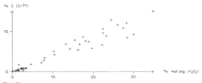
Fig. 23 Comparaison des analyses de C : valeurs de C obtenues par calcination au H2SO4 conc. et K2Cr2O7 2N et valeurs de la substance organique perdue par calcination au H2O2 30% (45 échantillons de sols).
