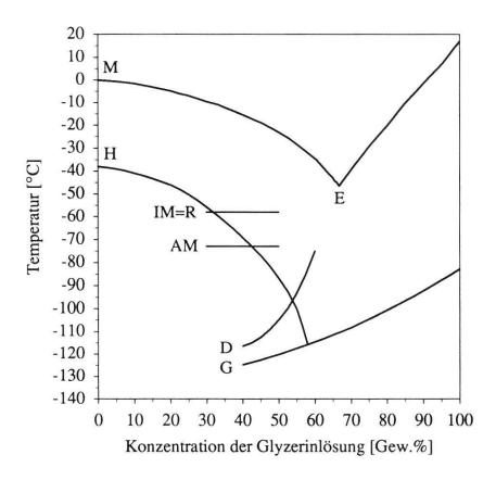
Fig. 1. Phasendiagramm wässeriger Glyzerinlösungen in Konzentrationen von 0-100%. Die Daten sind den Arbeiten von LANE (1925), LUYET (1970) und FAHY et al. (1984) entnommen.
