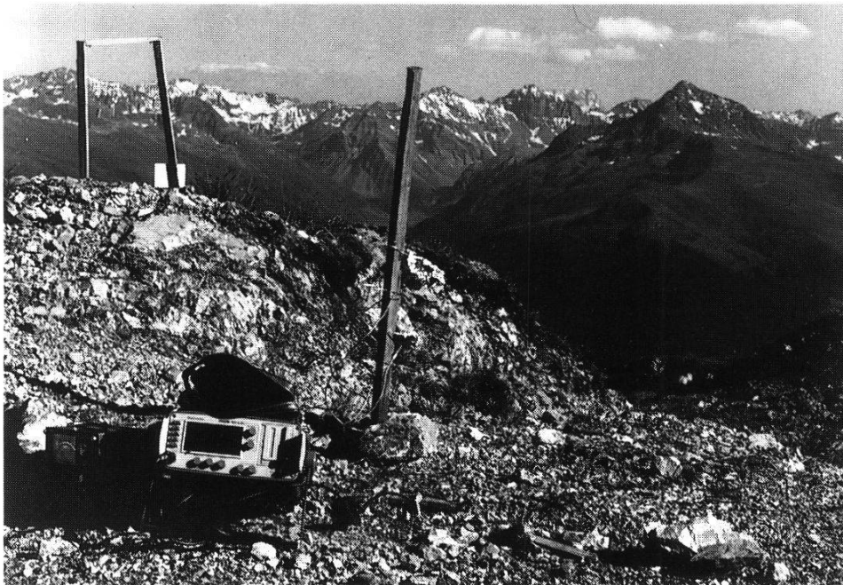
Fig. 8. Versuchsanordnung auf der Strela am Messtag 18./19. Juli 1989. Vordergrund: TDR- und Thermistorengerät; Hintergrund: Gestell mit Zuckerampullen. Arrangement on Strela at the measuring day 18./19. July 1989. Foreground: TDR- and thermistor device; background: rack with saccharose filled ampoules.
