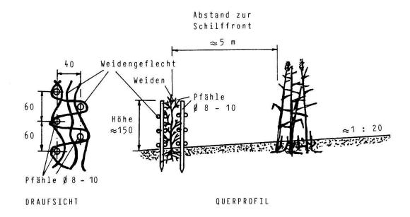
Fig. 2.3. Doppelreihiger Flechtzaun für das Schilfgebiet an der Seefelder Aachmündung. (Ausführung Wasserwirtschaftsamt Ravensburg 1988, Fig. nach Dittrich und Westrich 1988)
