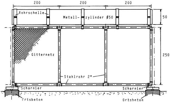
Fig. 2.2. Schwimmende Röhrichtsperre in Altenrhein SG. Lage und Anordnung sind im Situationsplan, Teil III, Fig. 3.6., unter der Bezeichunung "Schutzhag" eingezeichnet.
