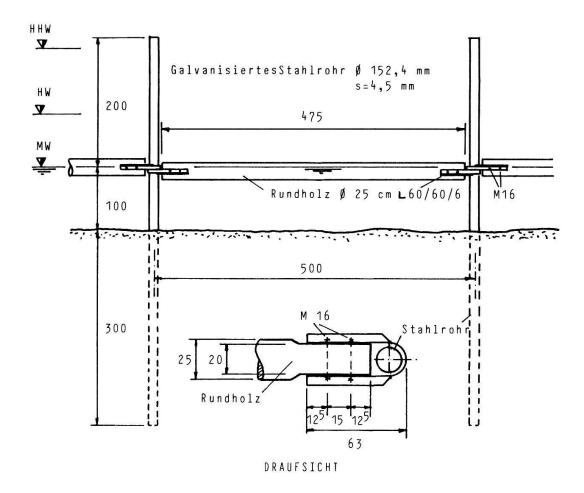
Fig. 2.1. Schwimmbalken als "Röhrichtsperre" nach SUKOPP (1973).
