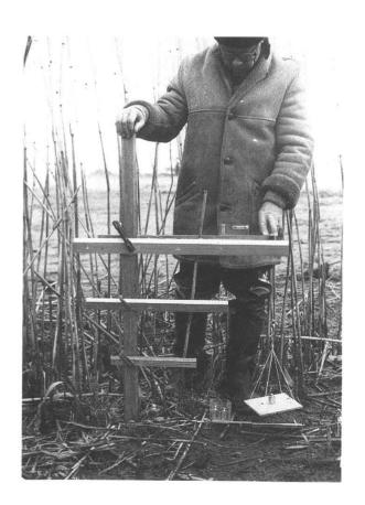
Fig. 5.3. Messung des Einspanngrades im Feld.
