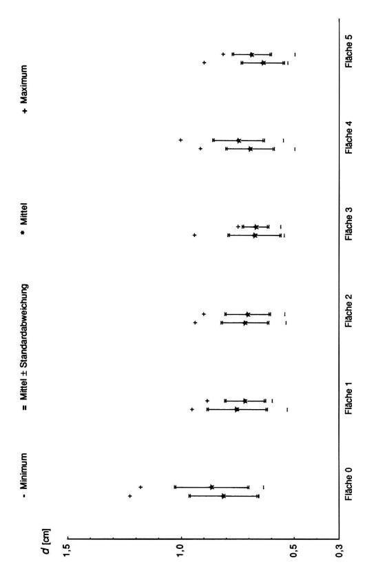
Fig. 4.3. Durchmesser der geprüften Schilfhalme aus Othfresen, unterste Stücke. Bei jeder Fläche von links nach rechts: Halme der Laborversuche (Kap. 3.4.2.), Halme der Federwaagenversuche.
