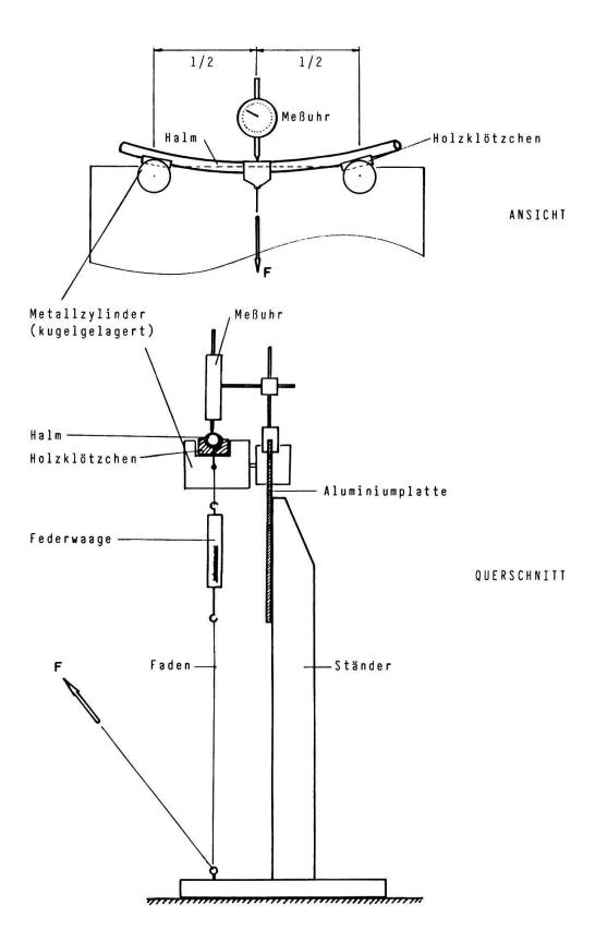
Fig. 4.9. Transportables Prüfgerät zur Messung der Biegesteifigkeit von Schilfhalmen.
