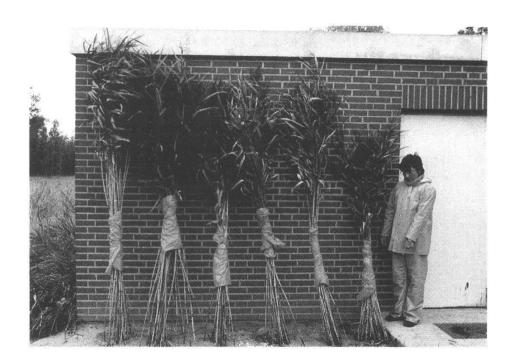
Fig. 3.48. Zur Biegeprüfung geerntete Schilfhalme in Othfresen. Jedes Bündel entstammt einer der Flächen 0 bis 5 (von links nach rechts). In der Schwarzweiß-Reproduktion nicht mehr sehr deutlich sichtbar ist der erhöhte Anteil an bereits vergilbten Blättern bei den stark belasteten Halmen der Flächen 3 bis 5. Die Größe der abgebildeten Person beträgt rund 1,60 m.
