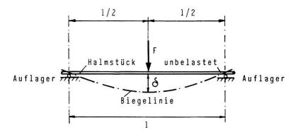
Fig. 1.5. Einfache Versuchsanordnung für einen Biegeversuch F = Belastung (z.B. Gewicht oder Federwaage)
