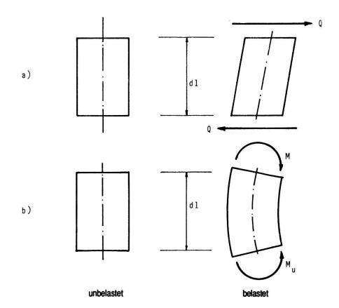
Fig. 1.2. Verformungen eines Stabelementes unter
