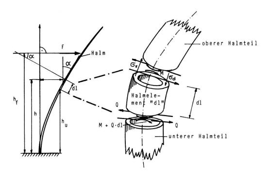
Fig. 1.1. Belastung und Beanspruchung eines Schilfhalmes.
