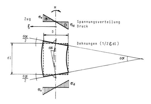
Fig. 1.4. Belastetes Halmelement mit eingezeichenten Spannungen und Dehnungen.
