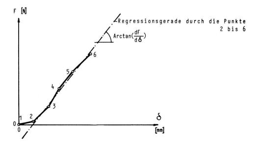
Fig. 1.8. Beispiel eines Biegeversuchs mit stufenförmiger Laststeigerung. Das zur Berechnung der Biegesteifigkeit erforderliche Verhältnis von Lastzunahme: Durchbiegungszunahme ( $dF/d\delta$ ) entspricht der Steigung der Regressionsgeraden durch die Punkte 2 bis 6. Wegen des Schlupfes zu Beginn des Versuchs (Punkte 1 und 2) darf der Punkt 1 für die Regressionsrechnung nicht verwendet werden, ebenso alle Punkte, welche bei höherer Belastung außerhalb des linear-elastischen Bereichs liegen.
