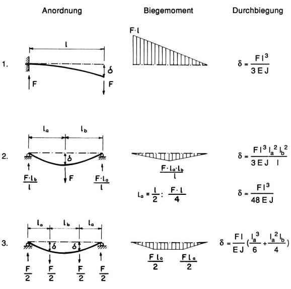
Fig. 1.7. Drei mögliche Prüfanordnungen für Schilfbiegeversuche, mit zugehörigen Auflagerkräften, Biegemomentverteilungen und Durchbiegungen.
