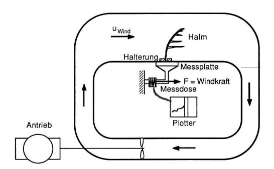
Fig. 3.4. Messung der Windkraft auf das Schilf im Windkanal. Schematische Darstellung der Versuchsanordnung (Windkanal am Aerodynamischen Institut der ETH).
