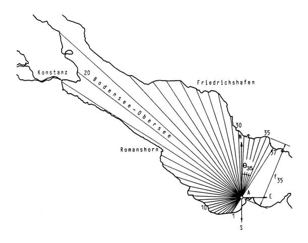
Fig. 3.22. Richtungsvektoren zur Berechnung der Streichlänge für das Versuchsfeld Altenrhein. Bezugsrichtung ist Nord, d.h. der Winkel  $\theta_i$  ist gleich dem Azimut des Richtungsvektors i.
