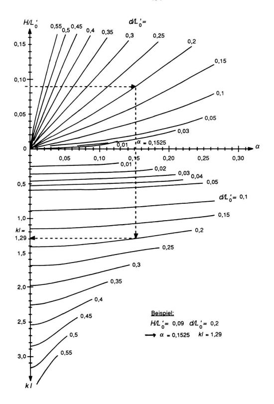
Fig. 3.26. Nomogramm zur Bestimmung der Parameter  $\alpha$  und kl nach der sinusoidalen Theorie dritter Ordnung (Stokes III), in Funktion der relativen Wassertiefe  $d/L_0$ ' und der relativen Wellenhöhe  $H/L_0$ '.  $(L_0'=g\ T^2/2\pi)$
