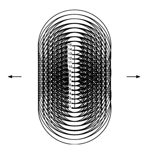
Fig. 3.11. Überlagerungsbild von je sieben Elementarwellen aus 15 punktförmigen (Störungs-)Quellen. Die Kreise stellen die Kämme der Elementarwellen dar. Durch die Überlagerung bilden sich parallele Fronten, welche sich nach links und rechts fortpflanzen.
