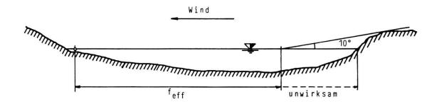
Fig. 3.21. Abminderung der Länge eines Richtungsvektors um den unwirksamen Teil bei Geländeneigungen von mehr als  $10^\circ$  am gegenüberliegenden Ufer.
