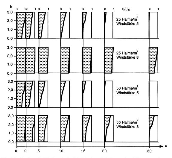
Fig. 3.1. Abnahme der Windgeschwindigkeit in einem Schilfbestand nach Werten von RUDEs-CU (1965). Dargestellt ist die relative lokale Windgeschwindigkeit bezogen auf die Windgeschwindigkeit  $u_0$  außerhalb des Bestandes. x ist die Entfernung [m] vom Bestandesrand, h die Höhe über dem Wasserspiegel.
