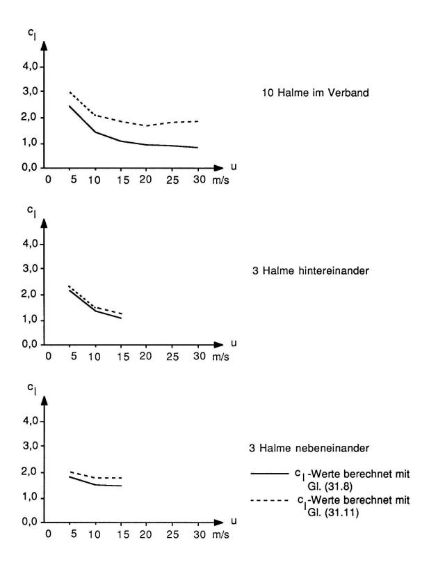
Fig. 3.9. Luftwiderstandsbeiwerte  $c_l$  in Funktion der Windgeschwindigkeit für einen Verband von 10 bzw. 3 Schilfhalmen (vgl. Fig. 3.5), bestimmt aus den Windkanalversuchen vom 17. 10. bzw. 11.10. 79.
