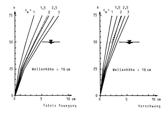
Fig. 3.16. Vergleich von gerechneten und gemessenen Ausschlägen eines Kunststoffhalmes von 1 cm Durchmesser unter dem Einfluß von Wellen mit einer Höhe von 12 cm (oben) bzw. 16 cm (unten). Totale Bewegung = Vorschwung + Rückschwung.
