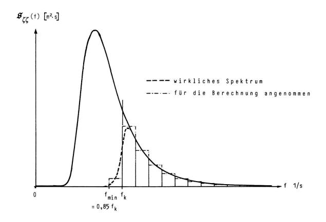
Fig. 3.27. Zusammenhang zwischen dem Spektrum des vollausgereiften Seegangs und jenem des entstehenden (kleine Figur oben), bzw. wegen begrenzter Streichlänge oder Winddauer nur teilweise entwickelten Seegangs (unten).
