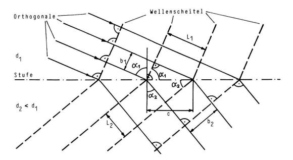
Fig. 3.29. Veränderung der Wellenform und -richtung bei einer plötzlichen Änderung der Wassertiefe d.
