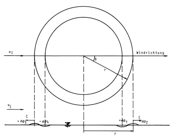
Fig. 3.18. Ausbreitung einer (gedachten) Elementarwelle bei wehendem Wind. Der von links nach rechts blasende Wind verursacht auf der linken Seite (Luv) eine Druckanstieg  $(+\Delta p)$ , auf der rechten (Lee) einen Druckabfall  $(-\Delta p)$ .
