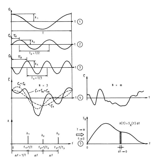
Fig. 3.14. Spektrum der periodischen und der unperiodischen Schwingung.
