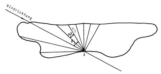
Fig. 3.17. Definitionsskizze zur Bestimmung der wirksamen Streichlänge für den Punkt A.
