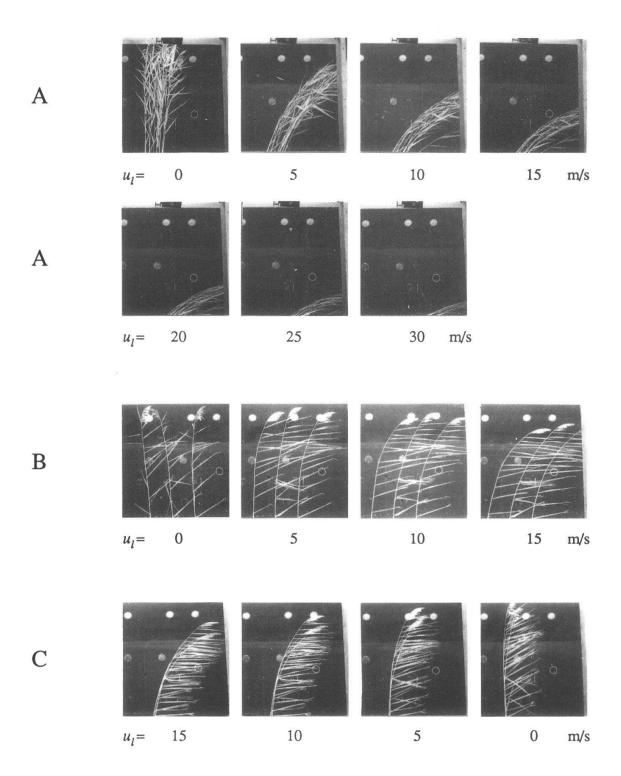
Fig. 3.5. Windkanalversuche mit Schilf.
