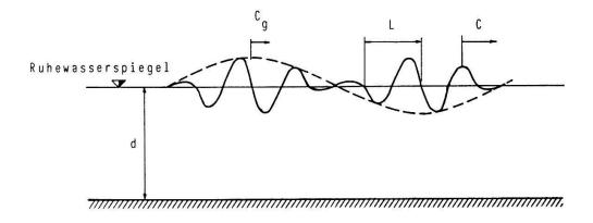
Fig. 3.24. Wellengruppe (gestrichelte Linie) als Umhüllende der Überlagerung zweier Wellen mit ähnlicher Frequenz (ausgezogene Linie).
