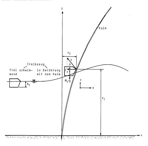
Fig. 3.43. Definitionsskizze zu den Bewegungsdifferentialgleichungen (33.1ff) des Treibzeugs.
