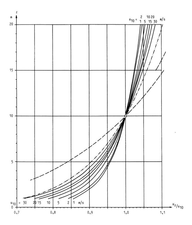
Fig. 3.23. Nomogramm zur Umrechnung von gemessenen Windgeschwindigkeiten auf eine andere Höhe über Grund: Relative Windgeschwindigkeitsprofile, bezogen auf  $u_{10}$  in der Höhe 10 m über Grund; Kurvenparameter =  $u_{10}$  (nach Gleichung 32.65). Ebenfalls eingezeichnet sind Kurven des Potenzgesetzes (32.66) mit den im Text erwähnten Exponenten.
