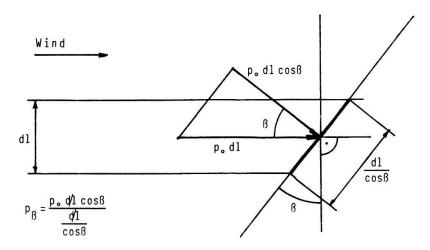
Fig. 3.19. Winddruck auf eine schief angeblasene Fläche.
