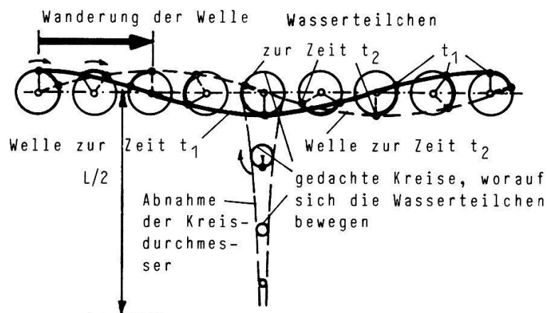
Fig. 3.32. Die Bewegung der Wasserteilchen, dargestellt am Beispiel einer flachen Welle im Tiefwasser. Sie ist in zwei Phasen dargestellt, zu einem Zeitpunkt t_1 und zu einem etwas späteren Zeitpunkt t_2 (z.B. eine halbe Sekunde später). Die Bahnkurven (Orbitalbahnen) der Wasserteilchen sind hier geschlossene Kreise. Der dick ausgezogene Teil der Kreise stellt die Bewegung einiger Wasserteilchen zwischen den beiden Zeitpunkten dar. (Bemerkung: Die Zeichnung ist nicht maßstäblich, Wellenhöhe und Durchmesser der Orbitalbahnen sind im Verhältnis zur Wellenlänge zu groß. Dies gilt auch für die folgenden Figuren 3.33. -3.35..) (Aus BINZ 1980)
