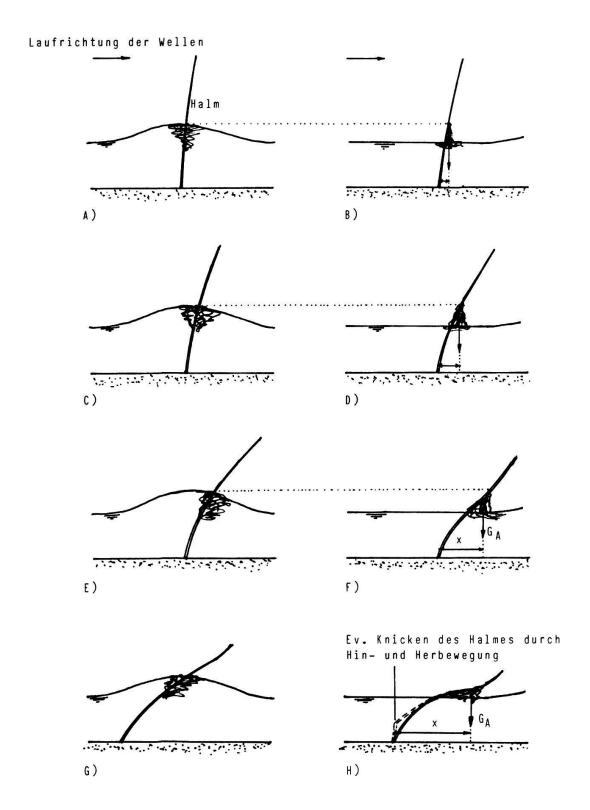
Fig. 3.42. Einzelne Phasen der Halmzerstörung durch ein Algenpaket (Schema). Je nach vorhandenem Wellenklima können zwischen den einzelnen Phasen längere Ruhepausen liegen. Hat der Halm eine bestimmte Schräglage erreicht, so wirkt sich sinkender Wasserstand in ähnlicher Weise aus (vgl. Fig. 3.39.).
