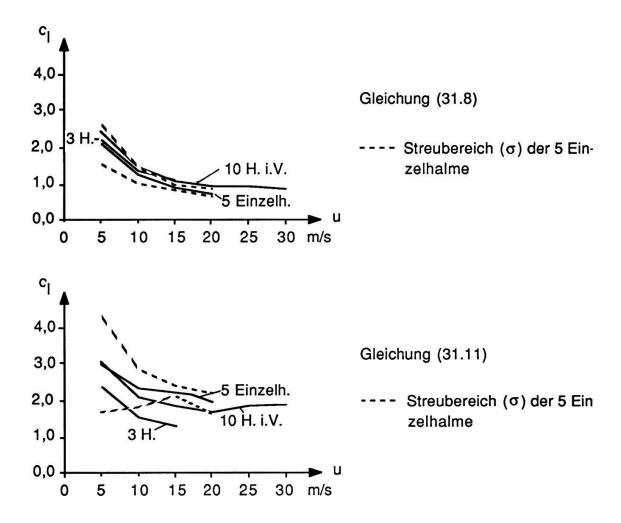
Fig. 3.10. Vergleich der Luftwiderstandsbeiwerte  $c_l$  in Funktion der Windgeschwindigkeit für den Verband von 10 Halmen, 3 Halme hintereinander und den Mittelwert der 5 Einzelhalme (bei den höheren Geschwindigkeiten nur 4 bzw. 3 Halme berücksichtigt; vgl. Text). Oben:  $c_l$  Werte berechnet mit Gl. (31.8).
