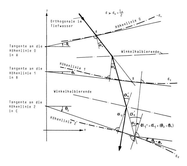
Fig. 3.31. Schrittweise Konstruktion einer Orthogonalen zu den Wellenscheiteln bei nicht parallelen Höhenkurven des Untergrundes (die Wellenscheitel selbst sind wegen der Übersichtlichkeit nicht gezeichnet).
