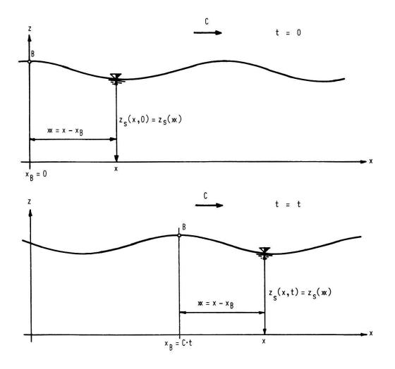
Fig. 3.36. Situation eines gedachten, auf der Welle im Punkt B mitwandernden Beobachters. Die Wahl des Punktes B ist natürlich frei, zur Verdeutlichung wurde hier ein Wellenscheitel gewählt.
