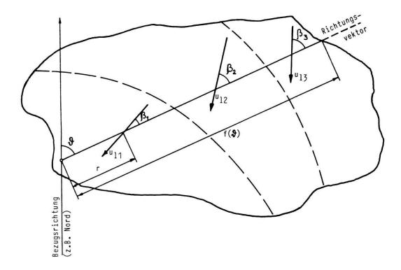
Fig. 3.20. Einteilung des Windfeldes in Zonen gleicher Windgeschwindigkeit und -richtung zur Berechnung der wirksamen Streichlänge nach Gl. (32.49).
