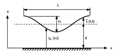
Fig. 3.12. Die wichtigsten Abmessungen einer Welle.
