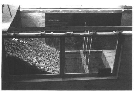
Fig. 3.47. Halterung der Plastikstäbe in der Wellenrinne der VAW. Oben: Draufsicht und Längsschnitt. Unten: Blick durch die seitlichen Beobachtungsfenster.
