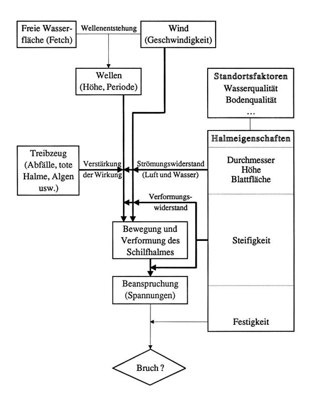
Fig. 1.1. Wirkung mechanischer Faktoren auf das Schilf. Die dick ausgezogenen Pfeile stellen die mit dem mathematischen Modell dieser Arbeit nachgebildeten Verknüpfungen dar (nach BINZ 1981, verändert).
