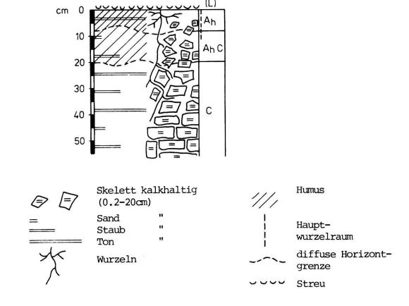
Abb. 2. Bodenprofil der Untersuchungsflächen
