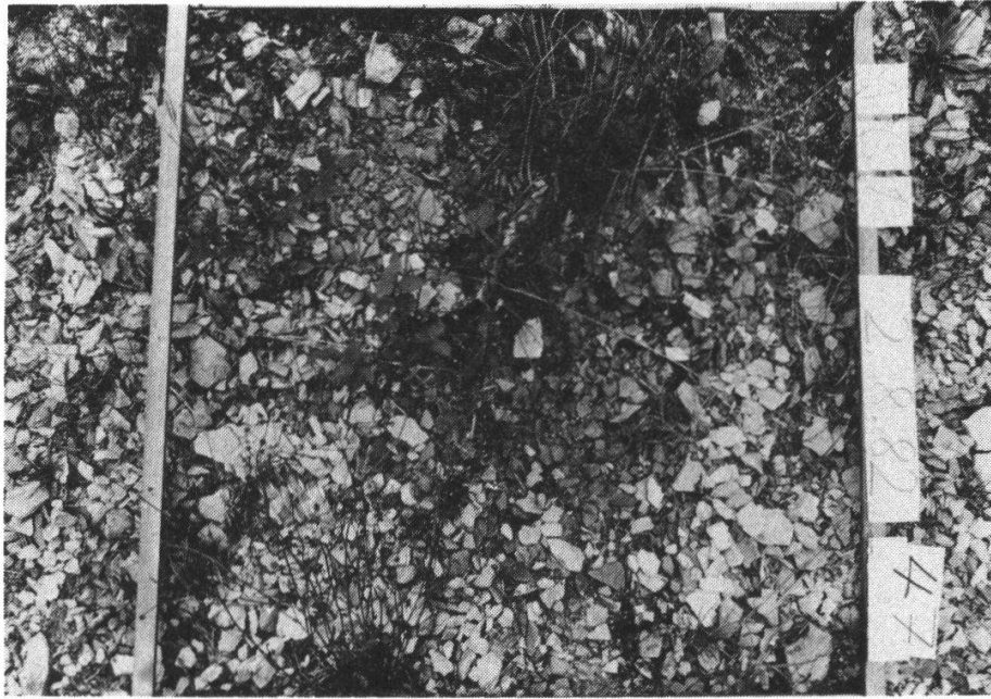
Abb. 5. Hoher Skelettgehalt des Bodens in einer Kontrollfläche der Böschung Asp.
