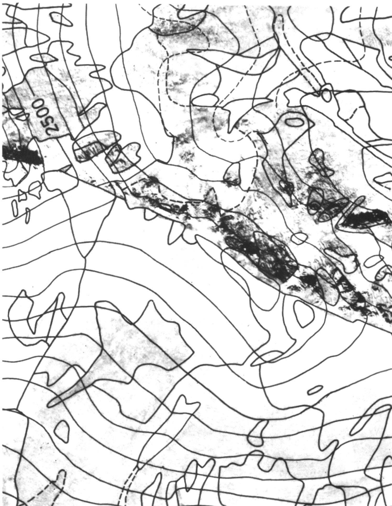
Abb. 11. Ausschnitt aus dem Orthobild 1:2500 des kartierten Gebietes (rechts eingerahmt) mit eingetragenen Vegetationsgrenzen und Höhenkurven. Reproduziert mit Bewilligung der Eidg. Vermessungsdirektion, Bern, und des Meliorations- und Vermessungsamtes GR, vom 10.6.1982. Zur Identifikation der Vegetationseinheiten vgl. Vegetationskarte (Beilage 1).
