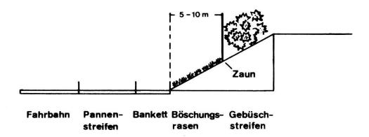
Abb. 1. Schematische Darstellung einer Böschung an einer Nationalstrasse.
