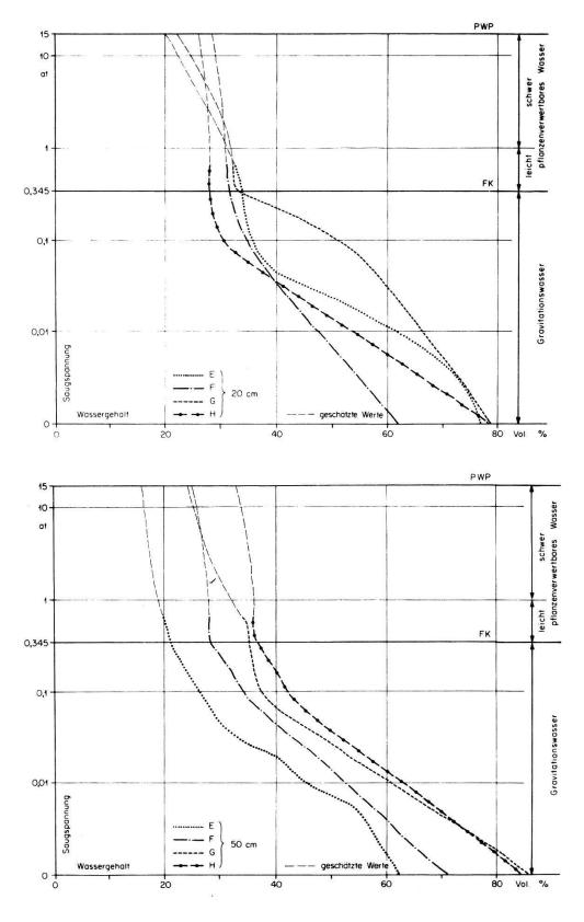
Abb. 22b. Vergleichende Darstellung der Desorptionskurven der Böden auf "Weid", je in 20 cm und 50 cm Tiefe
