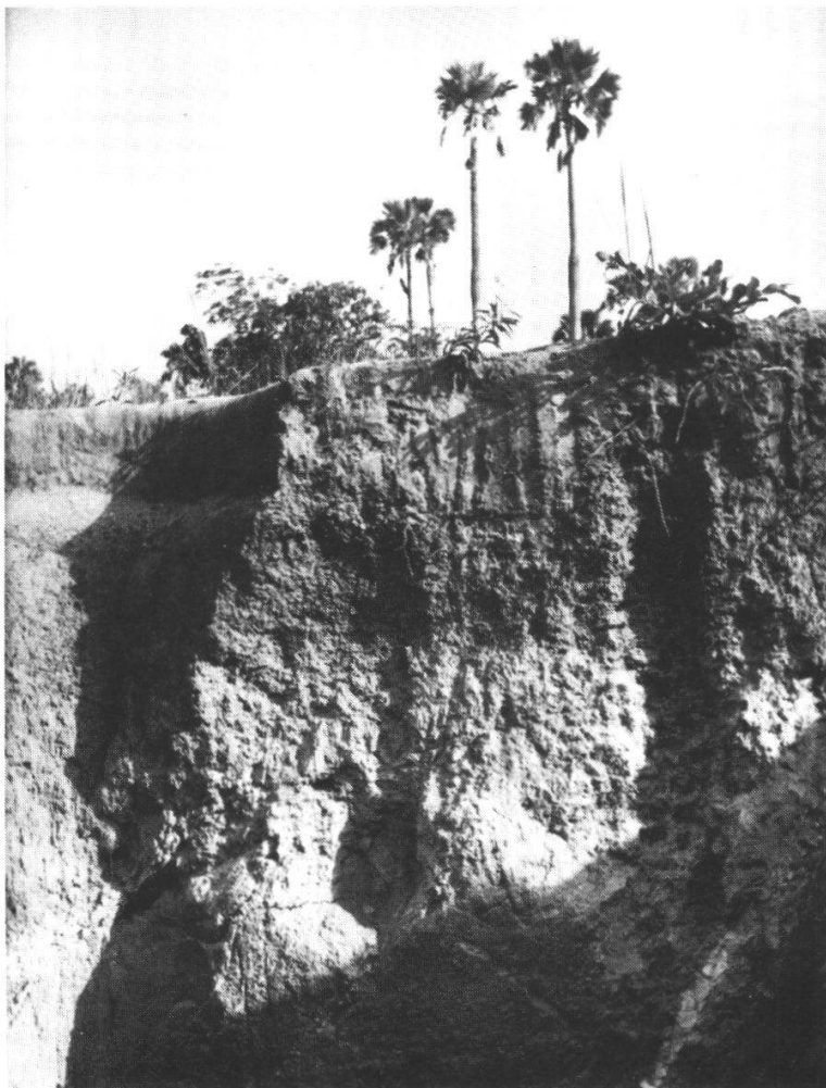
Photo 8 Profil de sol dans la savane de Lamto, station 4. On distingue nettement les principaux horizons: 1° horizon supérieur sableux, environ 30 à 40 cm, 2° couche de gravillons, environ 40 à 50 cm, 3° roche altérée (granit). Les filons de gneiss sont encore bien visibles. Des racines d'arbustes ont encore été trouvées plus pro- fondément que le filon de gneiss en plein dans la roche à peine décomposée
