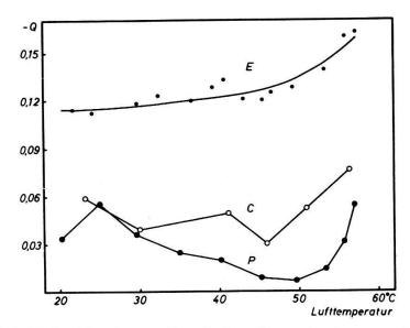
Abb. 4. Abhängigkeit des Quotienten Q zwischen Transpiration bzw. Evaporation und dem «physiologischen Sättigungsdefizit» der Blätter von Cucumis (C), Phoenix (P) und der Evaporimeterscheibe (E) in Abhängigkeit von der Lufttemperatur bei 30% rel. Luftfeuchte (vgl. Text)
