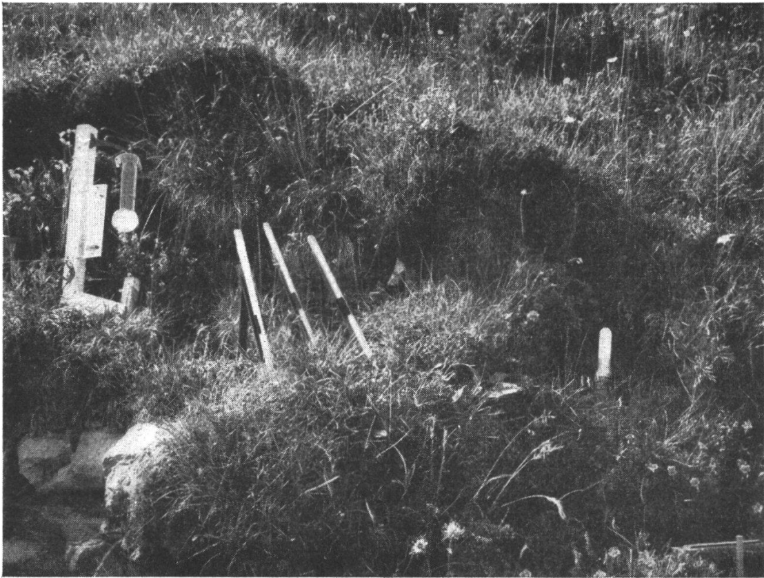
Abb. 58. Mikroklimatische Meßstation im unteren Seslerietum. Links Sixthermometer und Hygrometer, Mitte die drei Erdbodenthermometer, rechts Atmometer und zu äußerst rechts unten Photometer.
