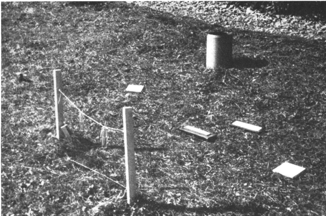
Abb. 74. Mikroklimatische Station im hinteren Nardetum: Zuckerampullen (beide auf der Bodenoberfläche liegenden Ampullen sind sichtbar), Regenmesser, Photometer, Tauplatten.
