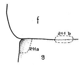
Abb. 21. Detail aus Profil III. Die Punkte zeigen die Verteilung der dem freien Auge sichtbaren Verunreinigungen der Schichten f und g. Die gestrichelte Linie grenzt die für die Proben 211 a und 211 b entnommenen Eisteile ab.
