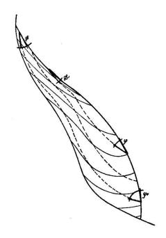
Abb. 3. Längsschnitt durch einen stationär und stetig bewegten Gletscher mit Stromlinien (strichliert) und Schichtgrenzen (ausgezogen) nach Finsterwalder).
