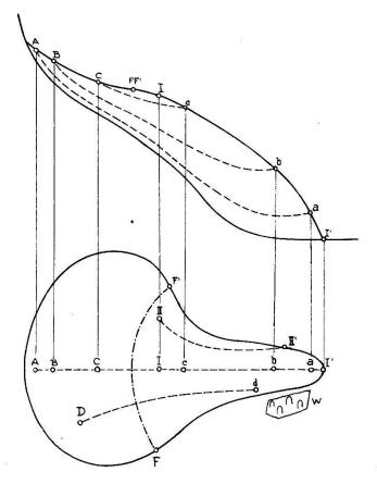
Abb. 1. Längsschnitt und Grundriß eines stationär und stetig strömenden Gletschers mit der Firnlinie FF', mit Stromlinien Aa, Bb, Cc und mit Bewegungslinien I I', II II' (nach Finsterwalder, verändert). W ein angenommener Waldfleck (s. S. 128).
