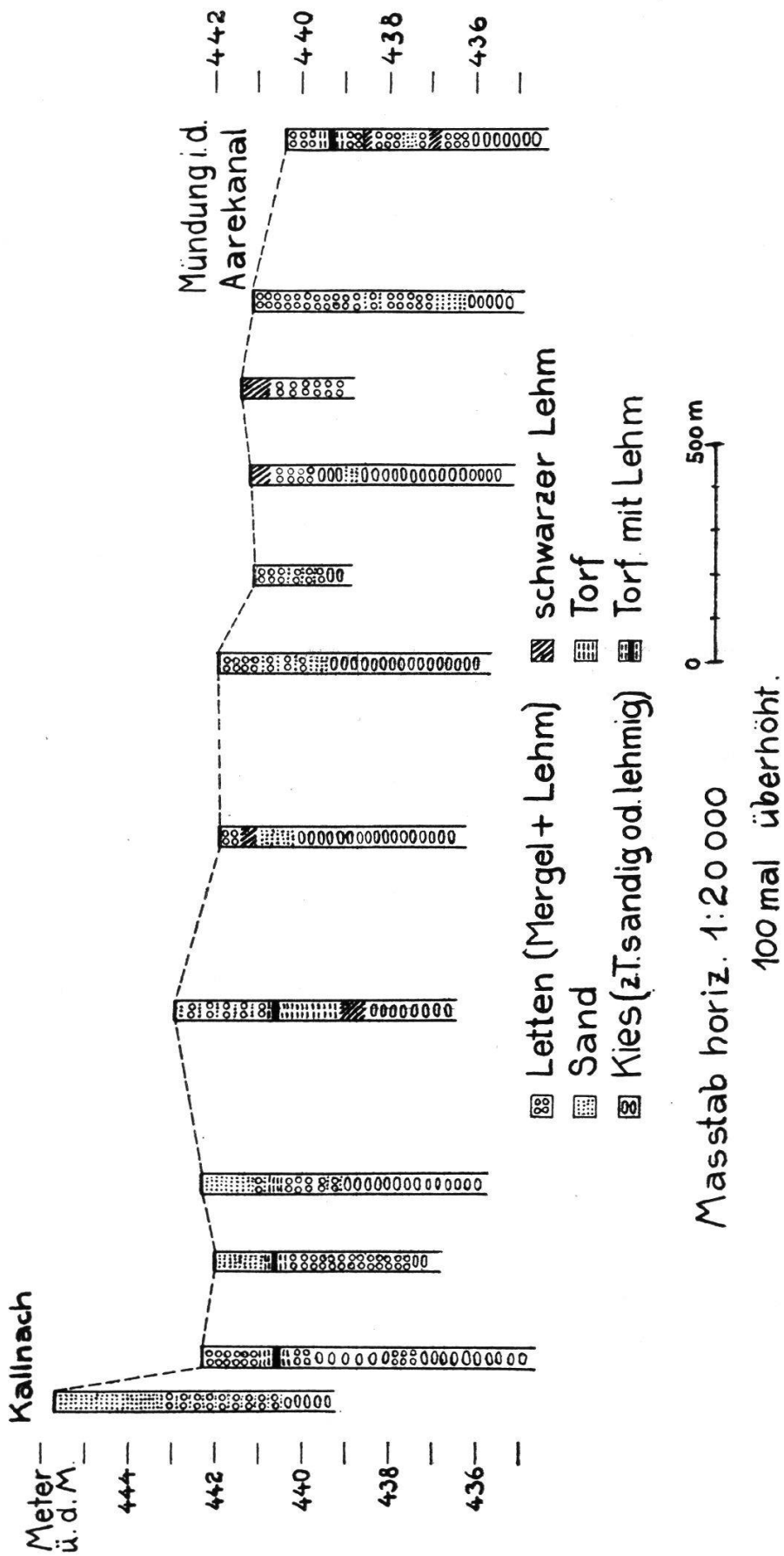
Abb. 15. Bohrprofil längs des Kallnachkanals, aufgenommen von den Bernischen Kraftwerken 1908.
