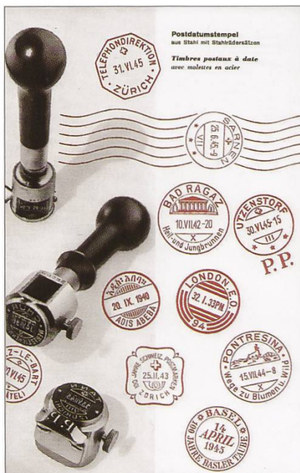
Abbildung 49: Postdatum-Stempel 1945 aus Stahl mit Stahlrädersätzen (Quelle: Festschrift «Güller Hüttikon – 100 Jahre Gravier- und Prägeanstalt»)
