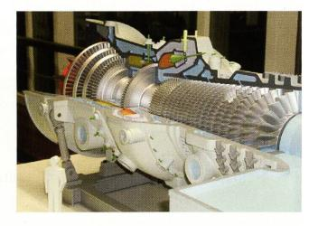
Rotoren einer Dampfturbine
