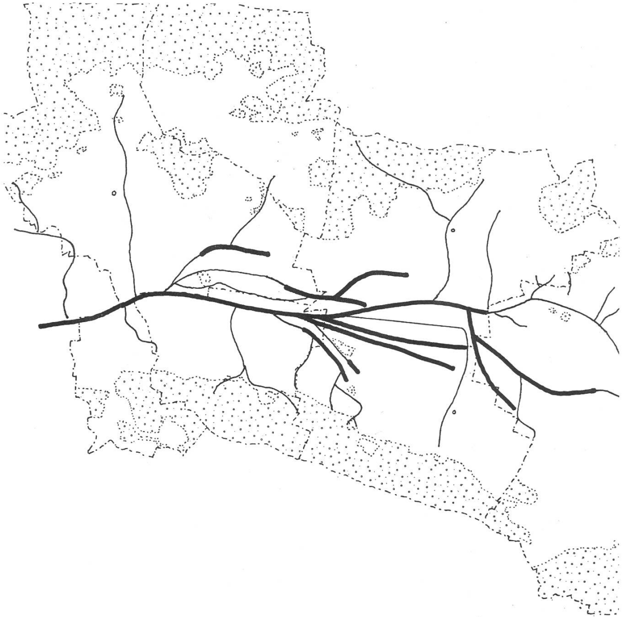
Die Massnahmen der Entsumpfung 1871/75 (aus LK 1: 25000, verkleinert) — = bestehend — = neu
