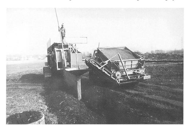
Moderne Maschine, die einen Graben öffnet und gleichzeitig die Drainagerohre einlegt.
