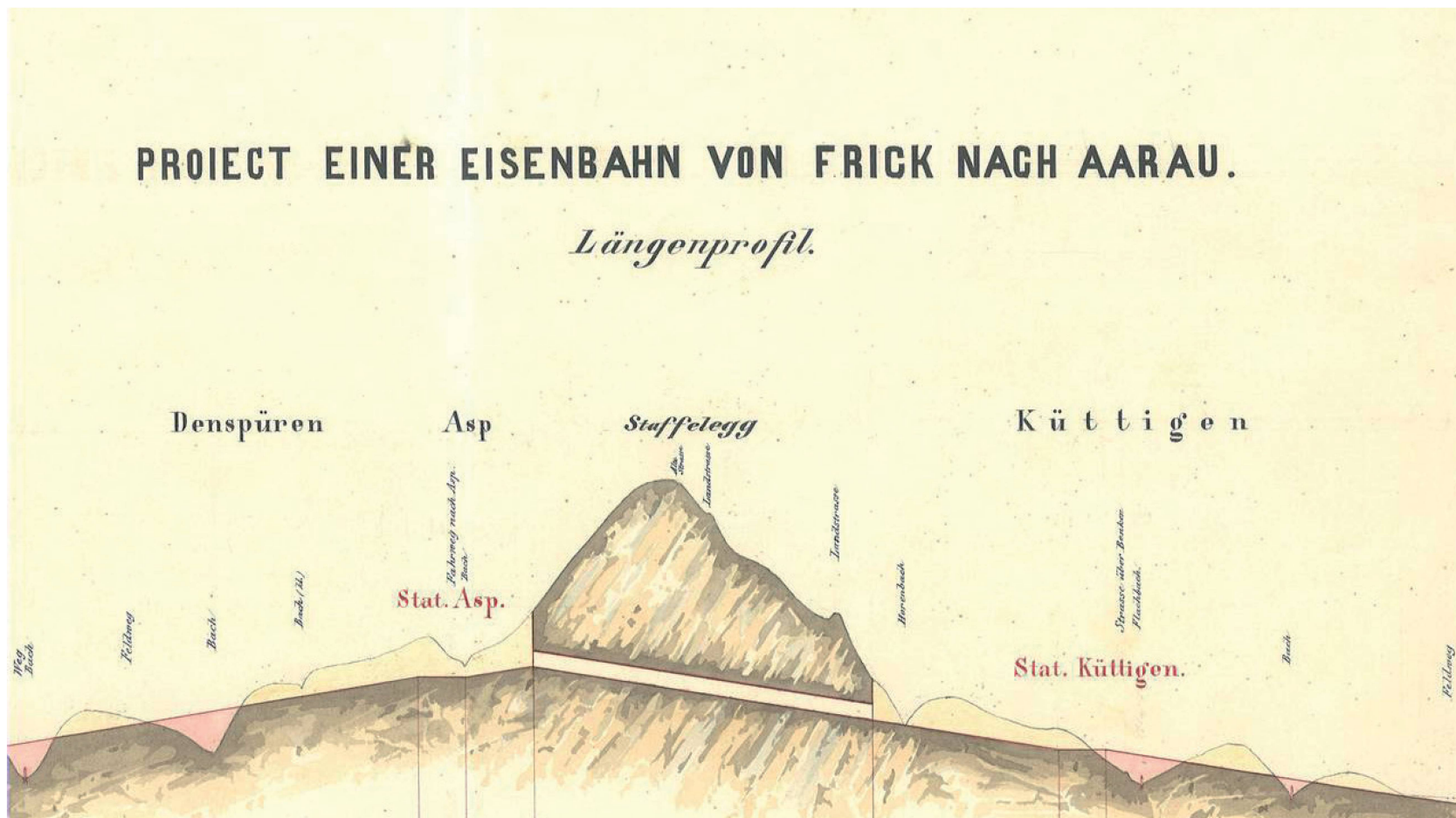
Längenprofil der geplanten Staffeleggbahn mit Scheiteltunnel.
