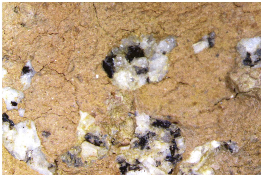
Abb. 17: Detailansicht der Granitmagerung.
