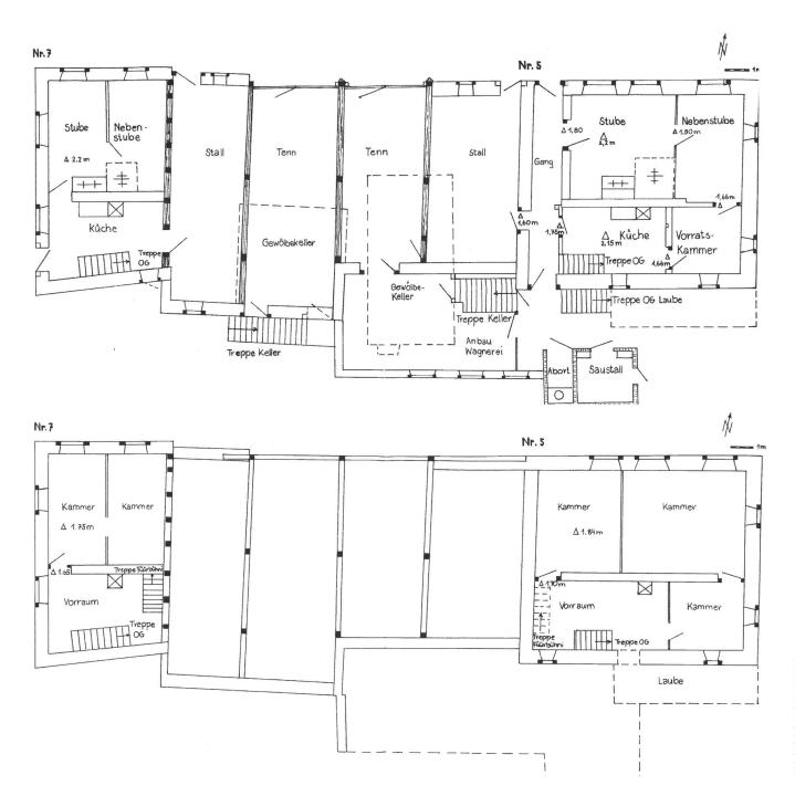
Frick, Kirchmattweg 5/7, Plan Grundriss Erdgeschoss und Obergeschoss. Der Schweinestall und der Abort liegen direkt hinter der Küche.
