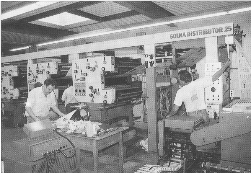
Neue Zeitungsrotations-Offsetmaschine SOLNA D-25, auf welcher 24 Seiten zweifarbig oder 16 Seiten vierfarbig gedruckt werden können.
