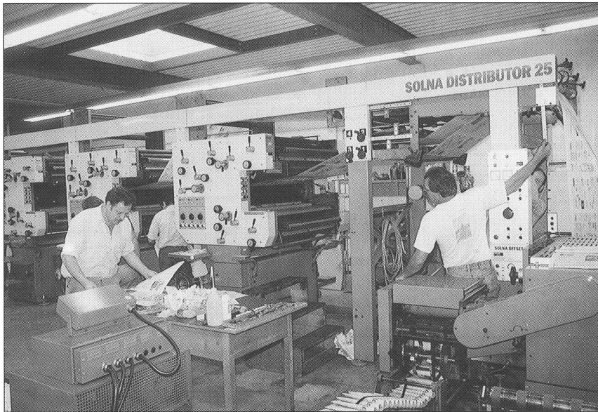
Neue Zeitungsrotations- Offsetmaschine SOLNA D-25, auf welcher 24 Seiten zweifärbig oder 16 Seiten vierfärbig gedruckt werden können.
