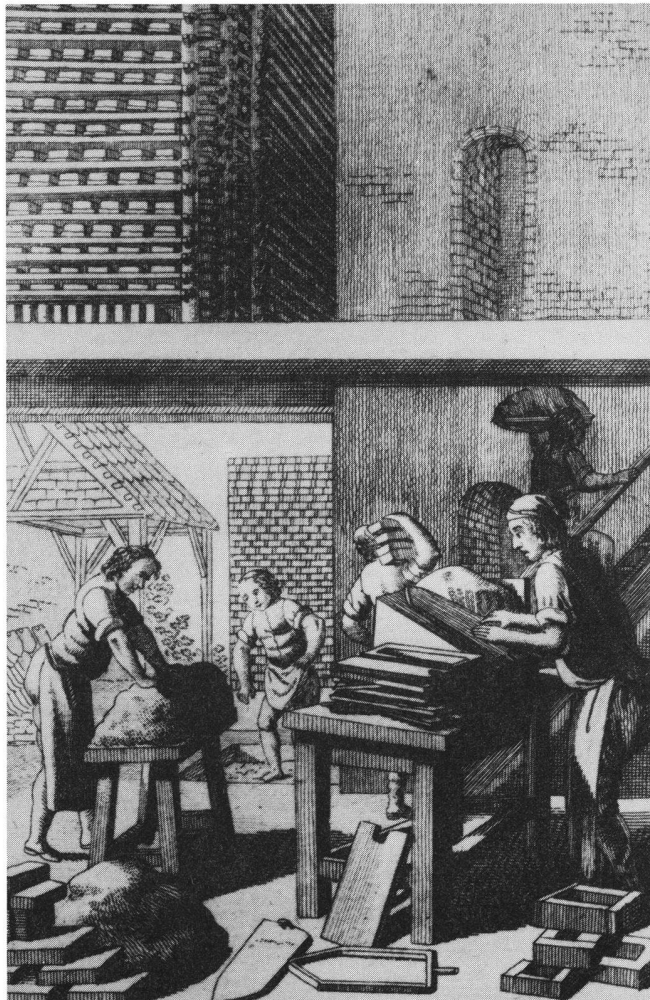
Abb. 5 Der Arbeitsablauf des Handziegelns in einer synoptischen Darstellung. Der Ziegelbrenner , Stich von G. Vogel nach A. Gabler. Slg. Ziegelei- Museum (ZM Reg.- Nr. 1104)
