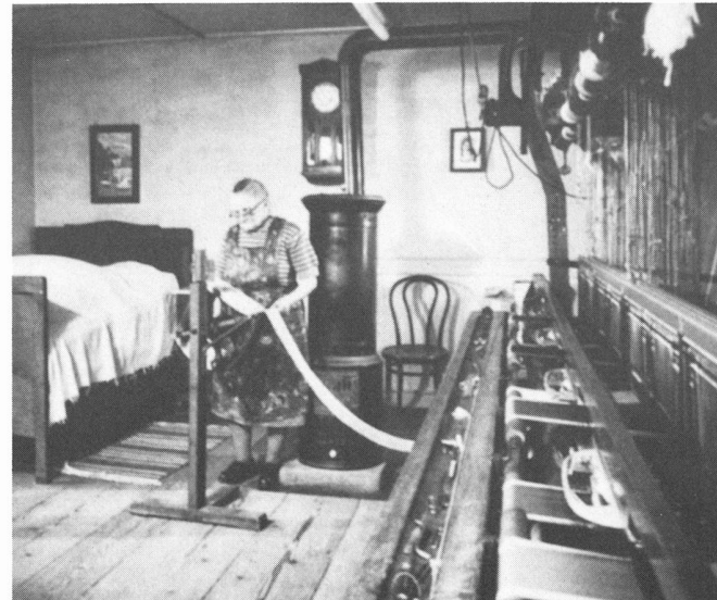
Martha Buser beim Abhaspeln der fertigen Bänder (für Schleifen an Grabkränzen). Man beachte die grossen Schiffchen des Posamentstuhles.
