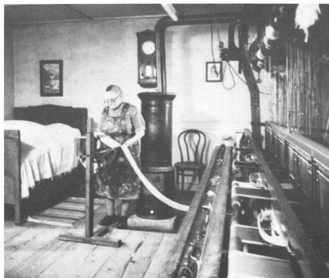
Martha Buser beim Abhaspeln der fertigen Bänder (für Schleifen an Grabkränzen). Man beachte die grossen Schiffchen des Posamentstuhles.
