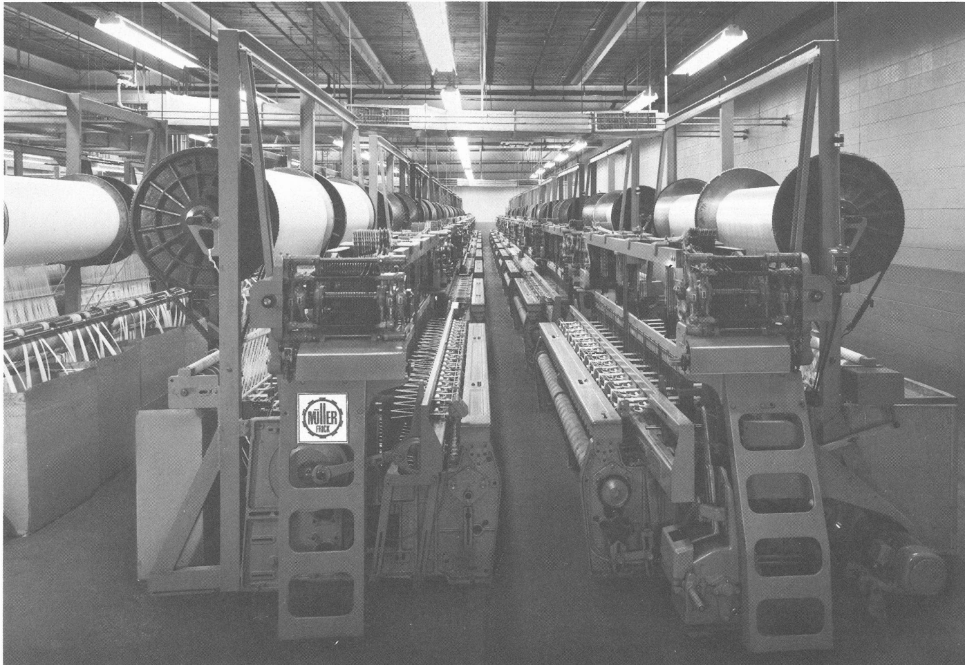
Schiffchen-Bandwebmaschinen COR 329 in einer modernen Weberei in USA
