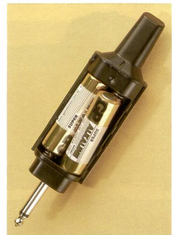
**Le récepteur de MicroSync Digital est alimenté par deux piles AA. Des batteries correspondantes peuvent aussi être utilisées en guise d'alternative. Le récepteur pèse 100 g.**
