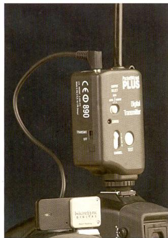
**Des dimensions lilliputaines:** le nouvel émetteur ne mesure que 27 x 51 x 11 mm pour un poids plume de 15 g. La pile bouton intégrée a une autonomie de trois ans.
