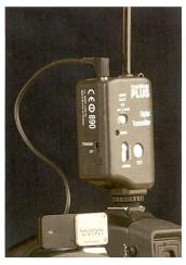
Des dimensions lilliputiennes: le nouvel émetteur ne mesure que 27 x 51 x 11 mm pour un poids plume de 15 g. La pile bouton intégrée a une autonomie de trois
