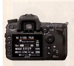
Nouveau reflex numérique Sony α700: un concurrent de plus dans la gamme moyenne. Le boîtier abrite un capteur CMOS de format APS-C offrant une résolution de 12,24 mégapixels.
