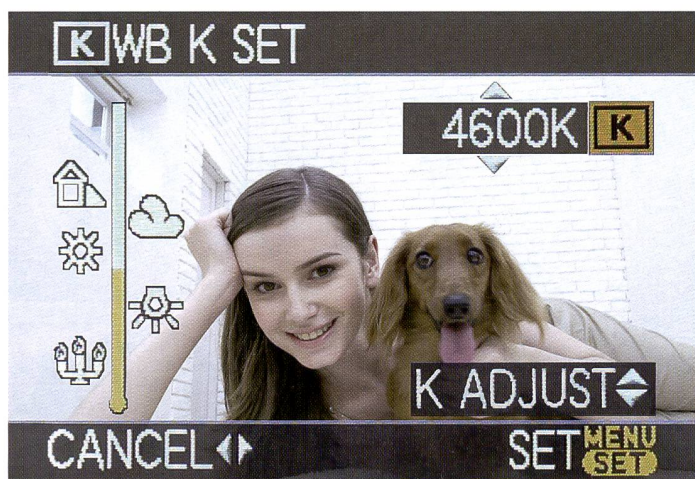
Les corrections de la température des couleurs et les adaptations de la balance des blancs se font directement à l'écran si bien que le résultat peut être contrôlé de suite.
