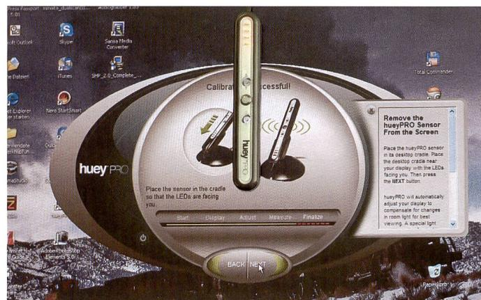
**Le colorimètre doit être placé sur l'écran pour calibrer ce dernier. Grâce à ses ventouses et pour peu que celles-ci ainsi que l'écran aient été préalablement nettoyés, il tient parfaitement dessus. Le processus de mesure et de calibrage ne dure que quelques minutes.**
